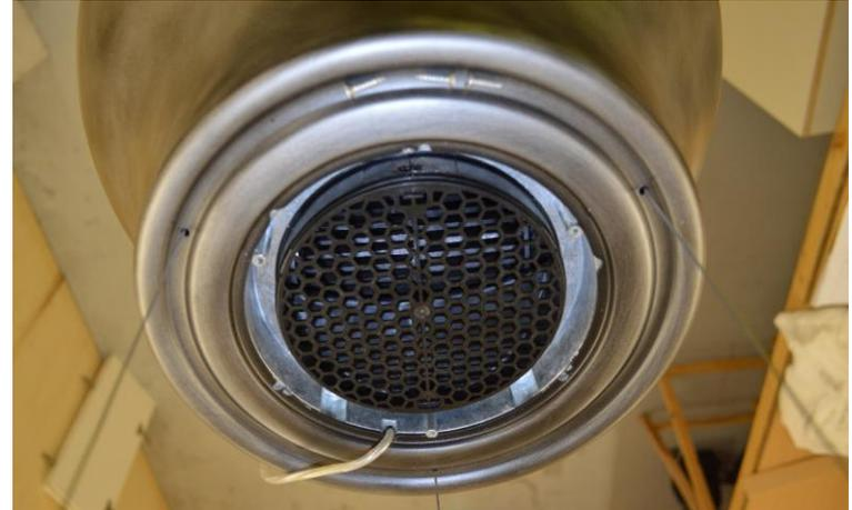
Unscrew 3 screws and remove the metal circular frame / Rimuovere 3 viti e rimuovere la cornice circolare in metallo
