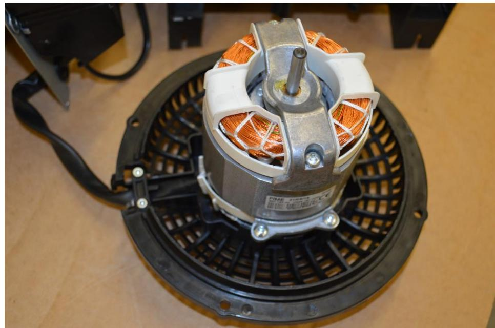
Unscrew 4 external screws and 4 motor screws. Remove the motor and unscrew the fan wheel and then 4 screws of the motor support and 2 of cableholder / Svitare 4 viti esterne e 4 viti del motore. Rimuovere il motore e svitare la girante e rimuovere 4 viti del supporto motore e 2 dal passacavo
