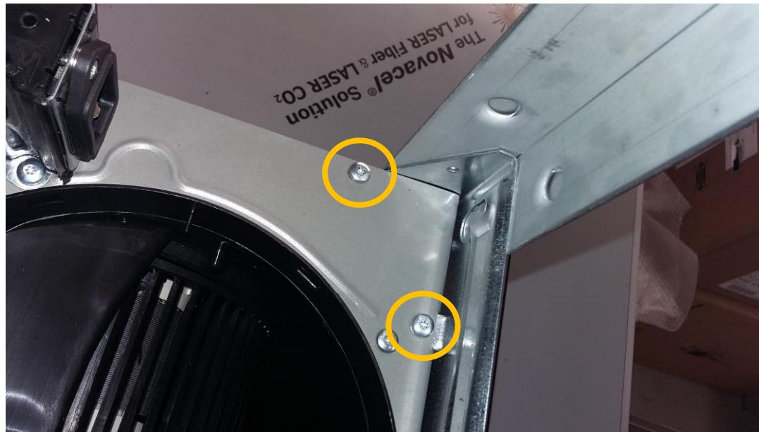
Disconnect all the electrical wirings, remove the electronic device box and unscrew the motor support bracket / Disconnettere tutte le connessioni dall'eletronica, rimuovere la scatola del dispositivo elettrico e svitare la staffa supporto del motore
