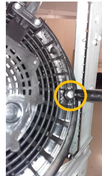
Lift-up the complete bracket with the motor in order to reach the conveyor support; unscrew the motor support (4 screws) / Sollevare la staffa completa con il convogliatore per arrivare al motore; svitare il supporto del convogliatore (4 viti)
