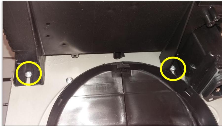
Unscrew the fixing screws of the electronic device: 2 + 4 about electronic box / Svitare le viti di fissaggio del dispositivo elettronico: 2 + 4 delle scatola elettronica
