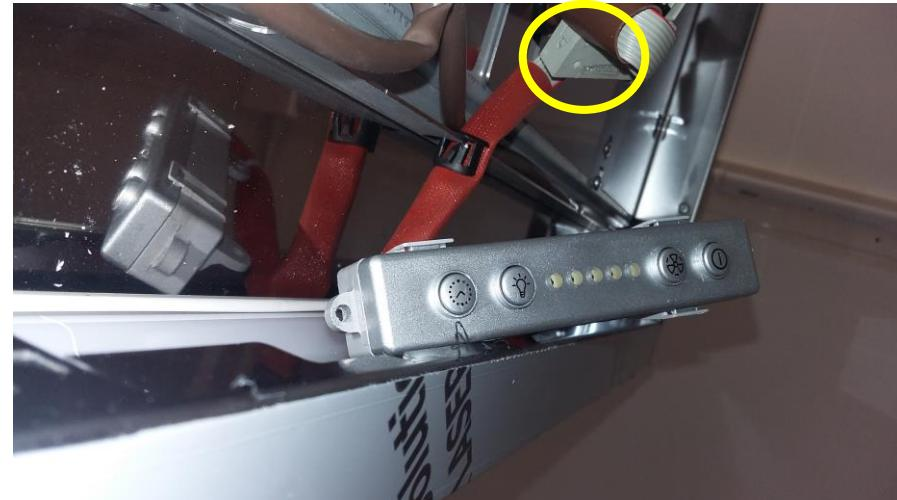
Unscrew the user interface and disconnect it from the wire / Rimuovere i filtri, svitare il comando e disconnettere il cabaggio dello stesso
