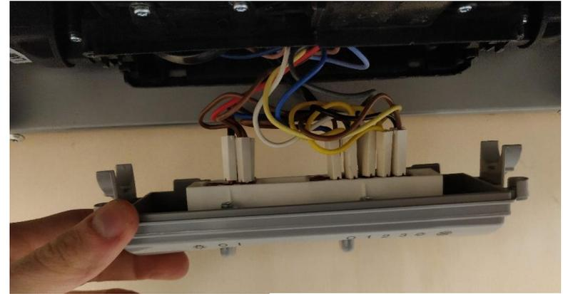
Unscrew n.2 screws to open the UI box / Rimuovere 2 viti per rimuovere la user interface. Disconnect all connections and replace UI panel. Weld to replace them. All components of UI are manage as spare parts / Disconnettere le connessioni e sostituire il comando. I componenti del comando sono gestiti come singoli ricambi
