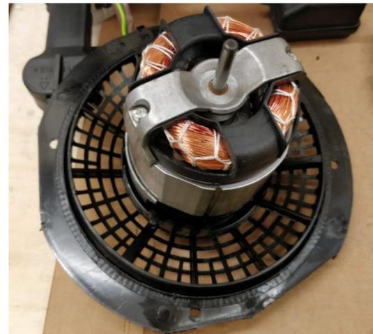
Unscrew n.4 screws Unscrew the nut to set free the impeller / rimuovere 4 viti e rimuovere il dado per sganciare la girante
