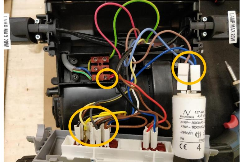
Extract the motor from the hood and disconnect every motor connections / Estrarre il motore dalla cappa e disconnettere le connessioni del motore
