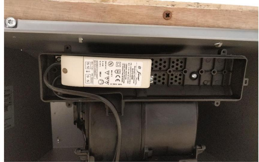
Unscrew n 6 screws. Replace Transformer / rimuovere 6 viti. Sostituire il trasformatore
