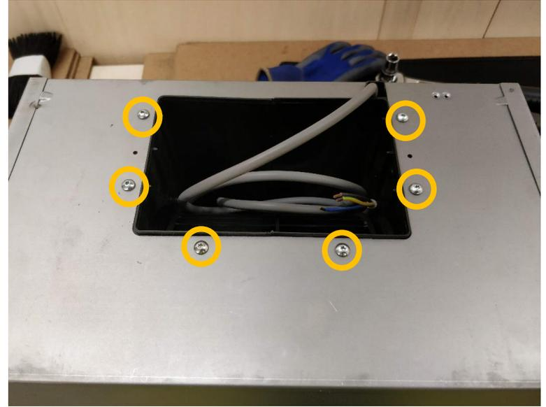
Unscrew n.2 screws and then remove n.6 screws / Rimuovere 2 viti e successivamente rimuovere 6 viti
