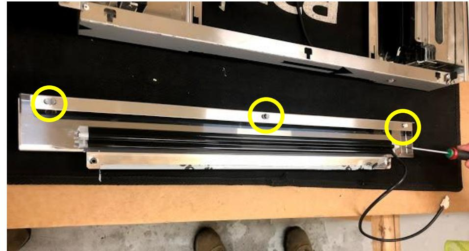
Attention: when pull out the lampa support take care about fixing / Attenzione: quando si estrae il supporto lampada fare attenzione ai fissaggi
