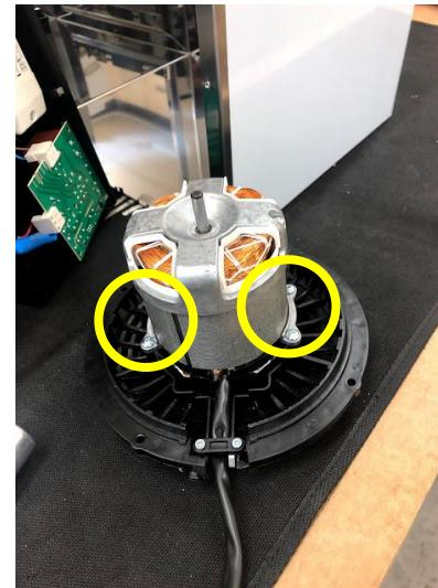
Open the nut and remove fan wheel. Then remove 4 screws to separate motor from motor support / Aprire il dado per rimuovere la girante. Successivamente rimuovere 4 viti per separare il motore dal suo supporto
