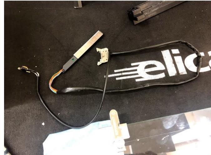
Remove the screw and pull out it from its seat. Wirings are connect with the UI / Rimuovere la vite ed estrarlo dalla sua sede. I cablaggi sono già connessi al comando
