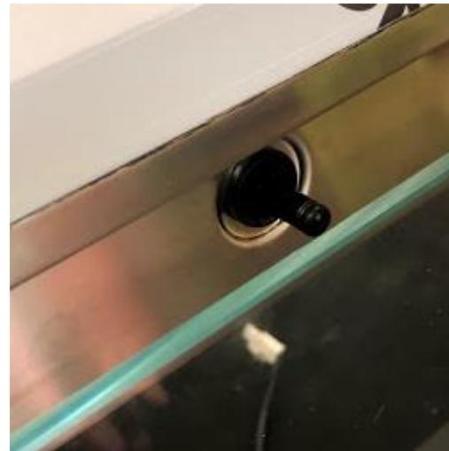
Remove the plastic cap / Rimuovere il cappuccio in plastica
