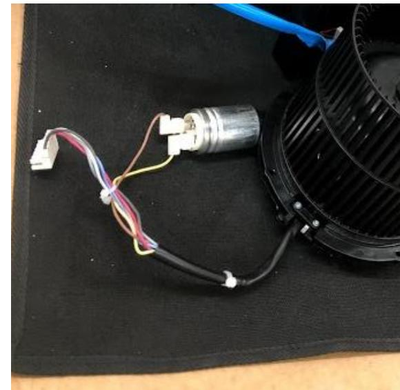
Remove the screws. Disconnect capacitor and motor connection from the electronic variator. Pull out fan wheel and motor from the conveyor / Rimuovere le viti. Scollegare il condensatore e il connettore del motore dalla scheda elettronica ed estrarre girante e motore dal convogliatore
