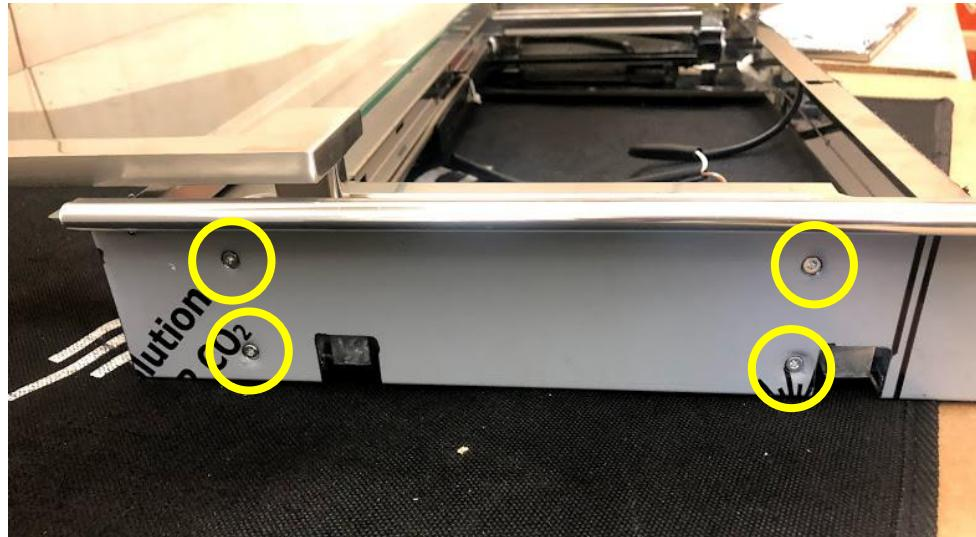
Remove 4 screws for each side of the hood (total 8 screws) / Rimuovere 4 viti per ogni lato della cappa (totale 8 viti)
