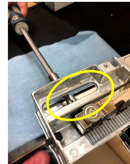
Remove the screws from each side. Take care about the bushing don't get lost. Remove the screws from the support / Rimuovere le viti da ogni lato. Fare attenzione che la boccola non si perde. Rimuovere le viti dal supporto
