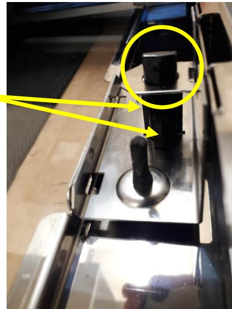
Turn the push-pull at 90° and press the lateral hinges to release them / Ruota il push-pull di 90° e premere gli agganci laterali per rilasciare il push-pull
