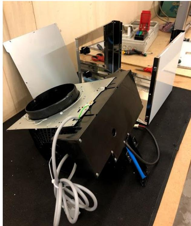
Remove 2 screws of the Earth wirings and remove electronic device and conveyor from the structure box / Rimuovere 2 viti del cablaggio Terra e rimuovere la scatola elettronica ed il convogliatore dalla struttura
