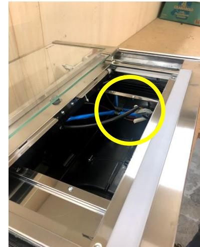
Remove 2 screws and disconnect the wires (UI and Lamps) / Rimuovere 2 viti e disconnettere le connessioni (comando e lampade)
