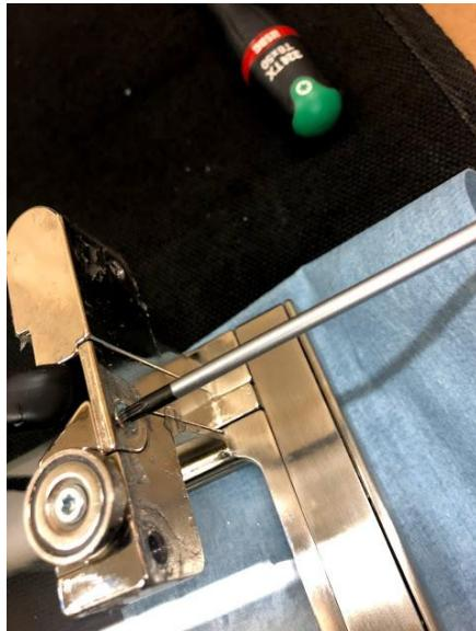
Remove the screw and separate the cover (black shim) from the glass panel / Rimuovere la vite e separare il supporto (black shim) dal pannello vetro
