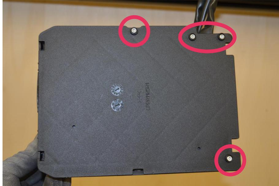
Open the electronic device box / Apri la scatola impianto elettronico
