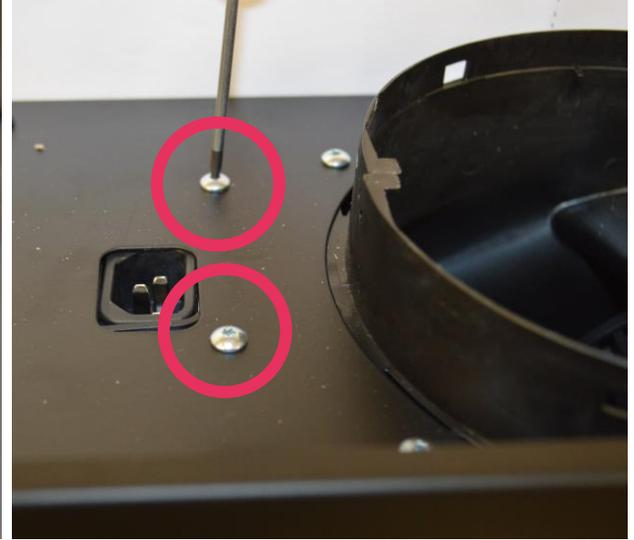
Remove the ground wiring, 2 screws from the bracket and the 2 upper screws. Hold the electrical box when unhooking the screws otherwise it may fall out / Rimuovere il cablaggio terra, le 2 viti dalla staffa e le 2 viti superiori. Tenere la scatola impianto elettrico quando si sganciano le viti altrimenti potrebbe cadere.
