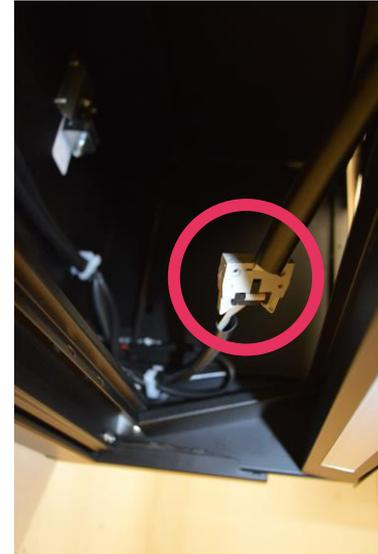
Remove 2 screws of the bracket and disconnect the wiring. / Rimuovere 2 viti dalla staffa e disconnettere il cablaggio.
