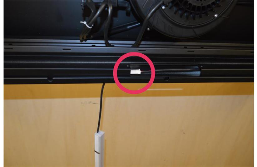
Use a flatten screwdriver in order to remove illumination from its seat and the disconnect the wiring / Utilizza un giravite a taglio per rimuovere la lampada dalla sede e disconnetti il cablaggio.
