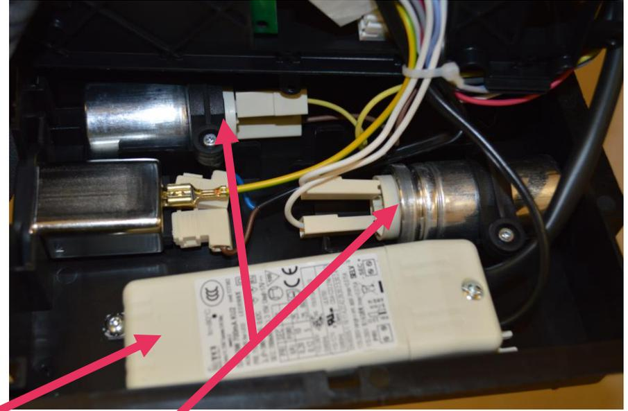
On one side CIRCUIT BOARD, on the other TRANSFORMER and 2 CAPACITORS. / Da un lato circuito elettrico, dall'altra trasformatore e 2 condensatori.
