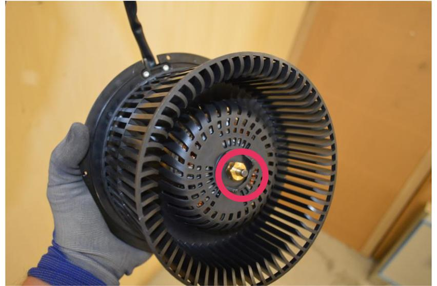
Remove 4 screws and pull out fan wheel and motor. To remove the fan wheel, loosen the nut, to completely remove the motor from its plastic support remove all the screws. / Rimuovere 4 viti ed estrarre girante e motore. Per rimuovere la girante allentare il dado, per togliere completamente il motore dal suo supporto in plastica rimuovere tutte le viti.
