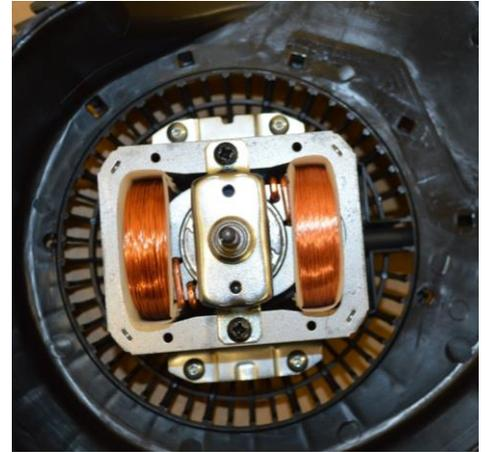
Attention: to replace lamps you have to disconnect a quick connector. To get access to the motor, unscrew the nut of fan wheel / Attenzione: per sostituire le lampade è necessario scollegare un connettore rapido. Per accedere al motore, svitare il dado della girante
