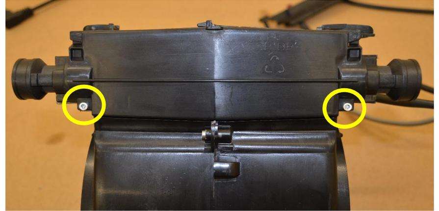
Unscrew 4 screws to unlock the cable and open it / Svitare 4 viti per sbloccare il cavo e aprirlo
