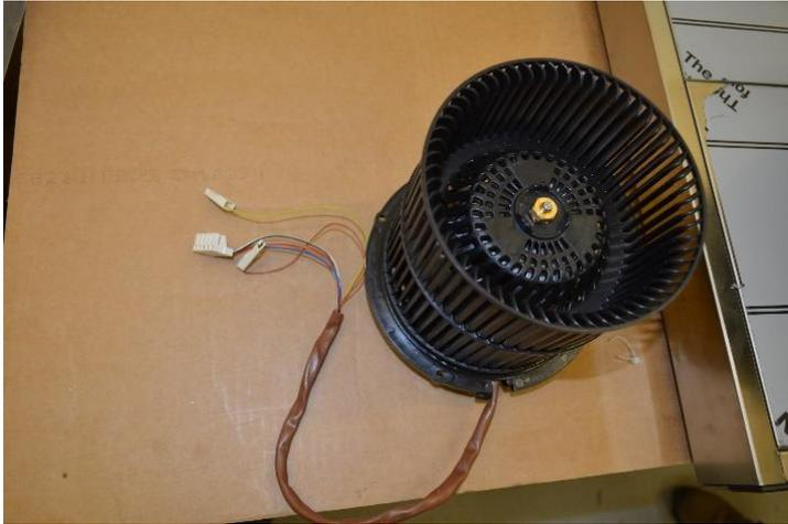
Remove Motor and unscrew fan wheel / rimuovere motore e sganciare la girante
