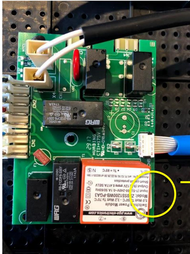
In the highlighted area it is possible to check the ELECTRONIC VARIATOR code and the production date about this component. / Nell'area evidenziata, è possibile controllare il codice del variatore elettronico e la data di produzione di questo componente.
