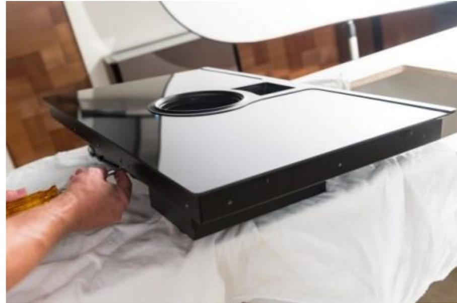
Spare part replacement: remove the glass / Sostituzione pezzo di ricambio: rimuovere il vetro
