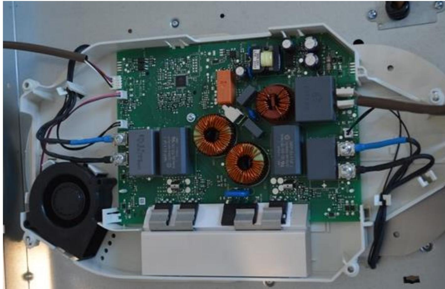
Spare part replacement: remove the INDUCTION PLATE / Sostituzione pezzo di ricambio:
