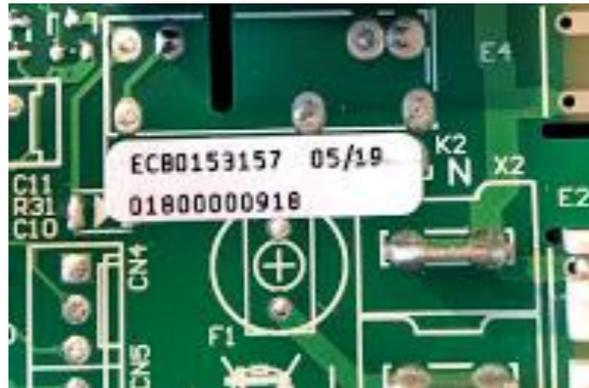
In the highlighted area it is possible to check the CIRCUIT BOARD code and the production date about this component. / Nell'area evidenziata, è possibile controllare il codice del circuito stampato e la data di produzione di questo componente.
